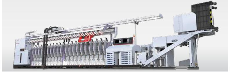
Autoconer 6 tipo D: flujo de material automático, llenado con carros de husadas, colocación donde se desee
