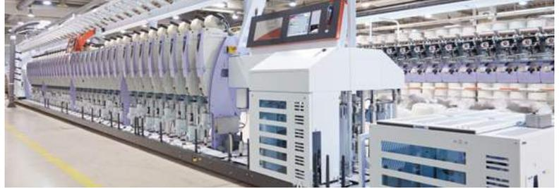
Autoconer 6 tipo V: combinación con la continua de anillos
